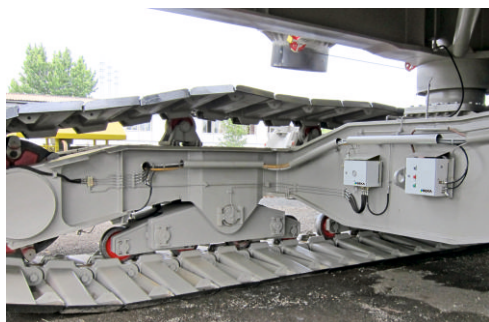
Sistema de lubricación de una excavadora
